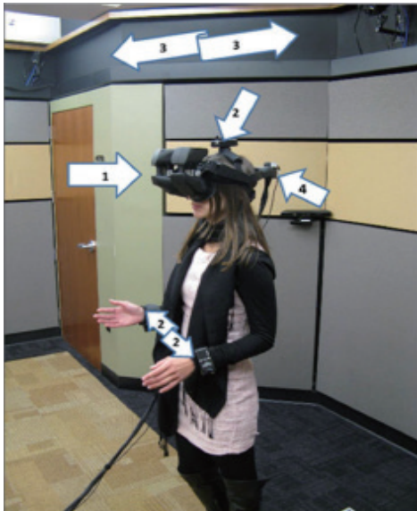
图 1: 头盔式呈现系统 (1) 头盔式显示器 (2) 头部和腕部的追踪传感器 (3) 相机 (4) 追踪器和定向装置
